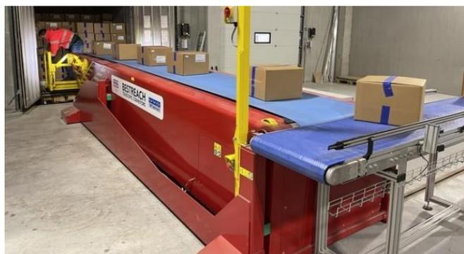
UVOTec installe pour le logisticien LuikNatie un convoyeur télescopique à bande dans son entrepôt réfrigéré implanté sur le port d'Anvers, en Belgique.
