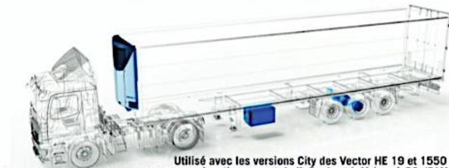
Utilisé avec les versions City des Vector HE 19 et 1550 E, le niveau sonore en fonctionnement de l'eCool est inférieur à 60 dB(A), respectant ainsi avec ses performances en matière d'émissions les réglementations d'accès aux centres-villes et zones urbaines.
